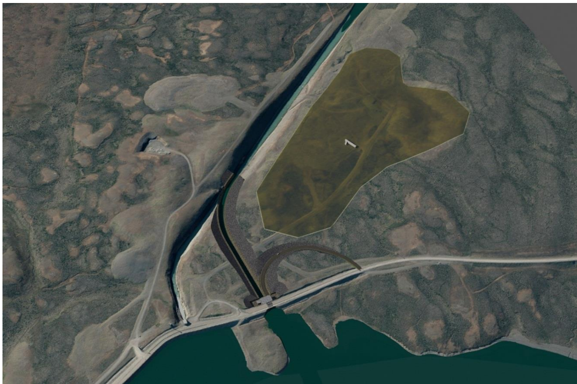
Mynd 46 Kolkuvirkjun. Sama sjónarhorn og að ofan. Horft til norðvesturs yfir nýtt inntak og stöðvarhús Kolkuvirkjunar, nýjan veituskurð, aðkomuveg og efnislosunarsvæði. Tölvugerð mynd.
