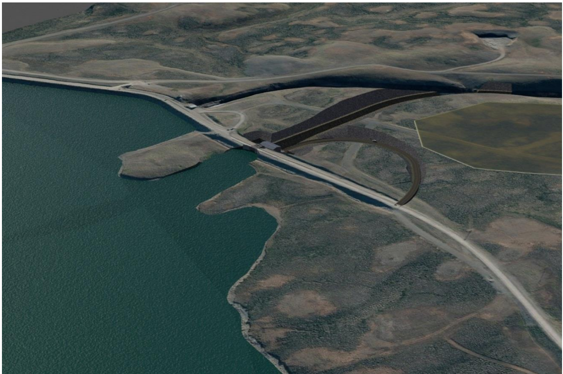
Mynd 48 Kolkuvirkjun. Sama sjónarhorn og að ofan. Horft til suðvesturs yfir fyrirhugað stöðvarhús og inntak Kolkuvirkjunar, nýjan veituskurð, aðkomuveg og hluta efnislosunarsvæðis. Tölvugerð mynd.
